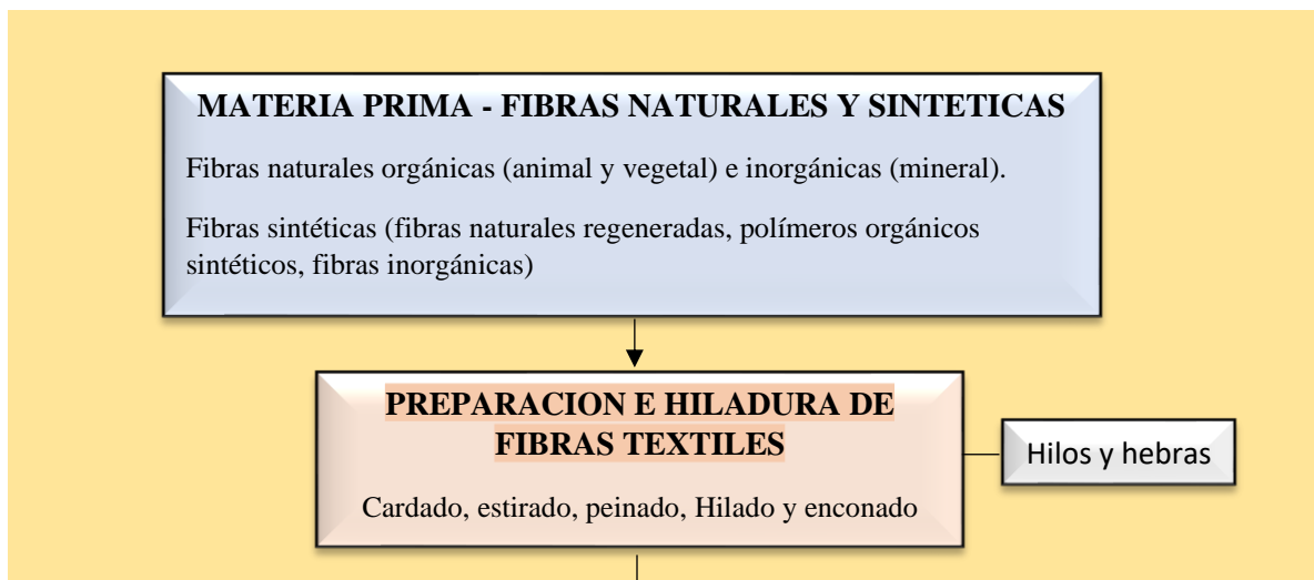
Diagrama 1. Estructura general del proceso de producción de la industria textil.
